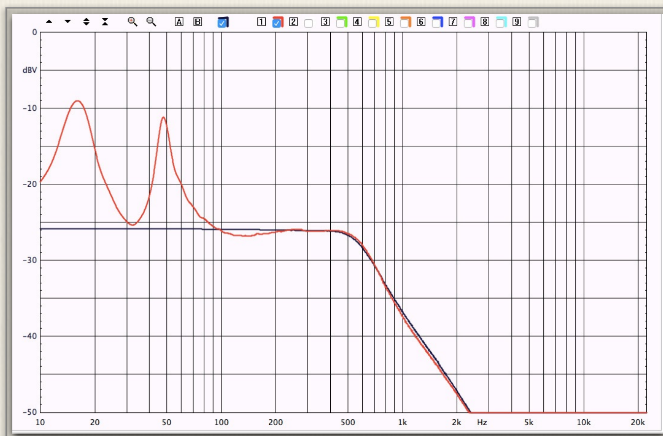
図3-17 真空管アンプへのスピーカーインピーダンス負荷と電圧特性
